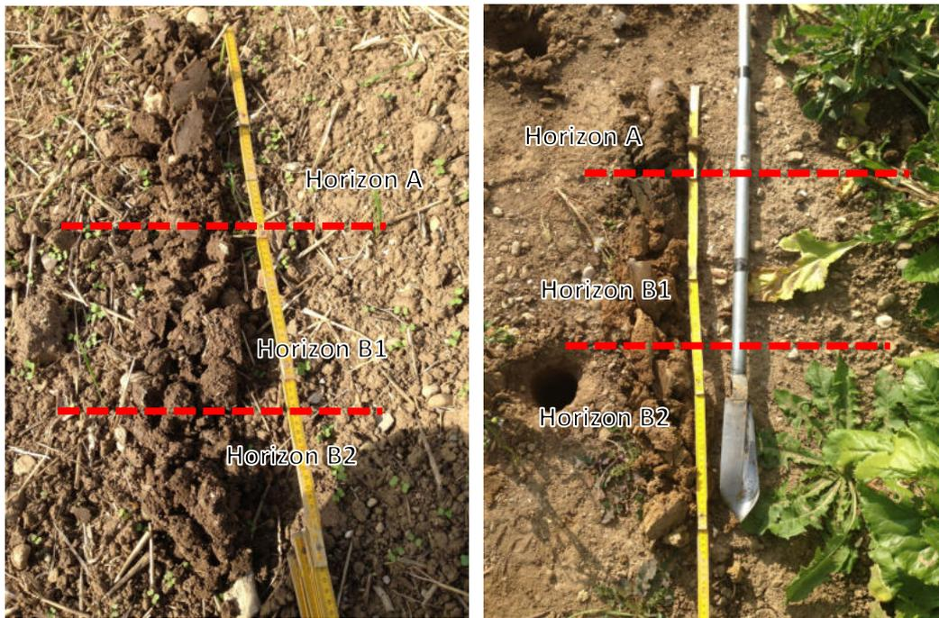
Figure 5.30 Profils de sol des deux sondages effectués sur le site du PA
