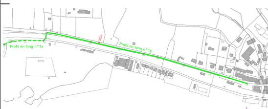
REMARQUE : Selon mesure préconisée par le PGEE communal, le tronçon entre chambre 3135 et chambre 3149 sera viabilisé par chemisage du collecteur existant. Sur ce tronçon selon proposition du service des travaux, la conduite d'eau sous pression serait remplacée.
