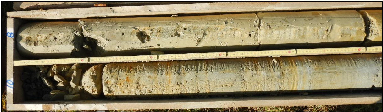
SC1 - De 8.00 à 9.00m (partie haute) et de 10.00 à 11.00m (partie basse)
