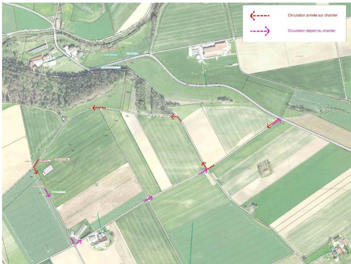
Figure 15 : Plan de circulation chantier
