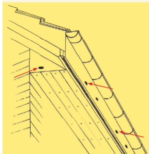
Sites de nidification dans le berceau. L'illustration montre les trous d'accès pour les Martinets noirs dans la planche de chêneau et une ouverture du côté du pignon.
