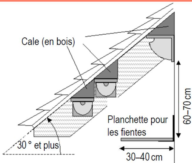
Si le toit est incliné à plus de 30°, il faut fixer les nids horizontalement. Attachez la planchette pour recueillir les fientes à la façade ou suspendez-la au toit (lien stable !). Placez-la suffisamment bas pour que l'accès au nid soit bien dégagé.
